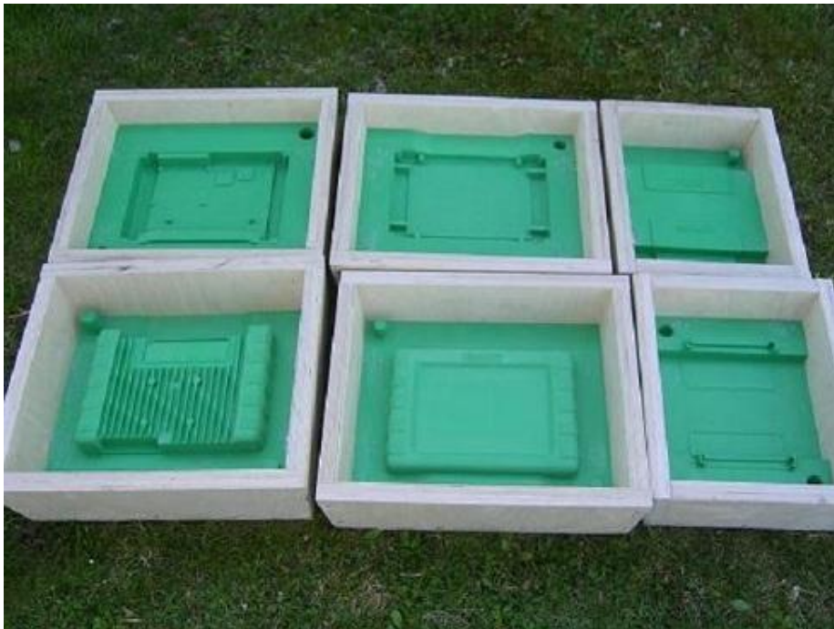
Gjuterimodeller till pekdatorchassi.
