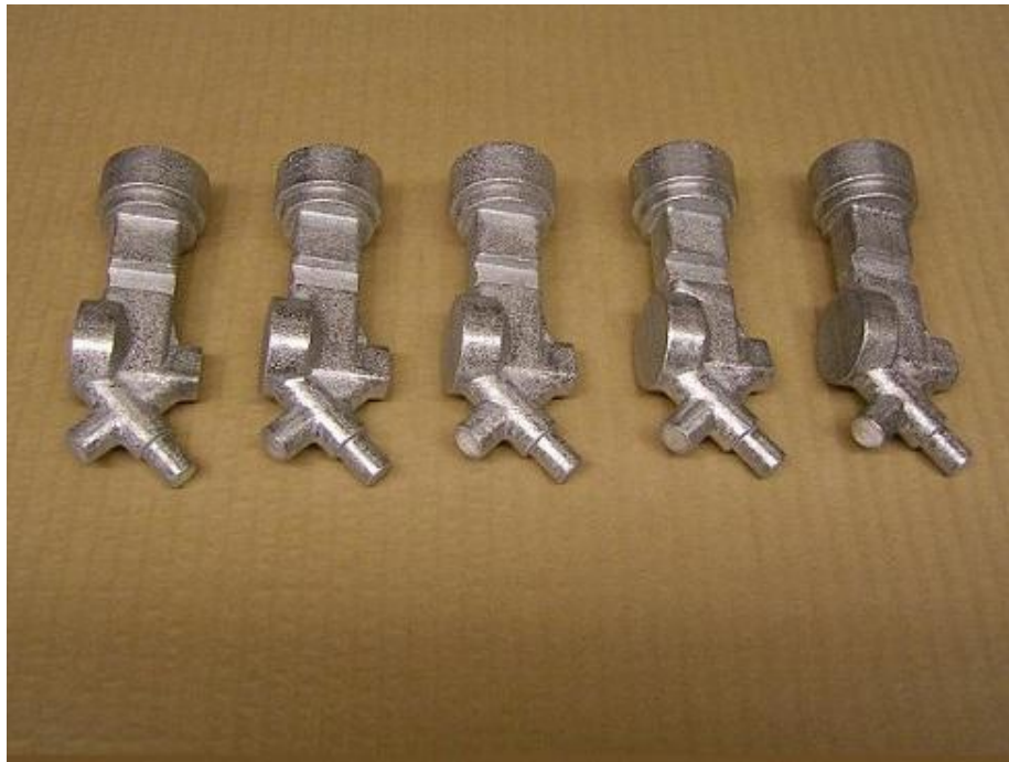
Zinkdetaljer innan efterbearbetning, gjutna i gjutblock 800.
