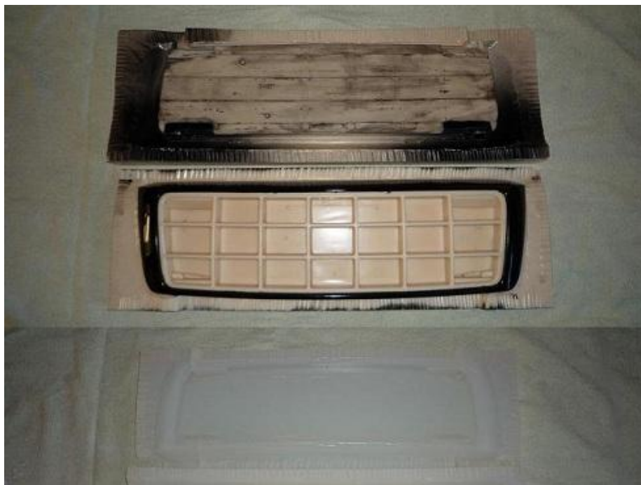
Masterform och silikonform till XC-grill.
