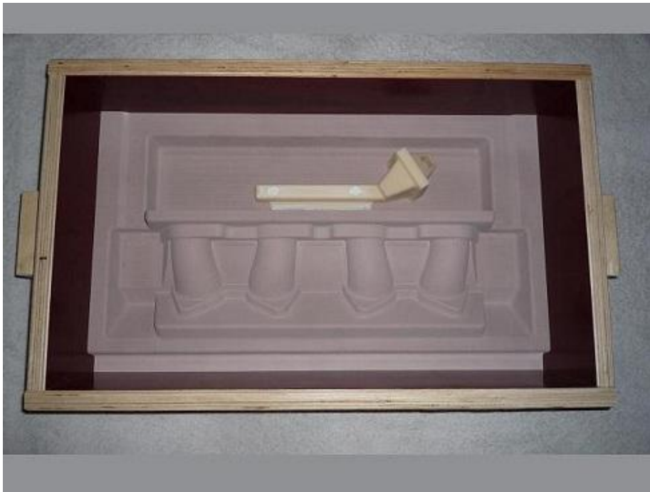
Ingötsida av gjuterimodell.
