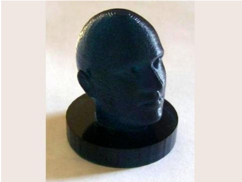
FFF-detalj från SD300. Storleken på botten är som en femkrona.
