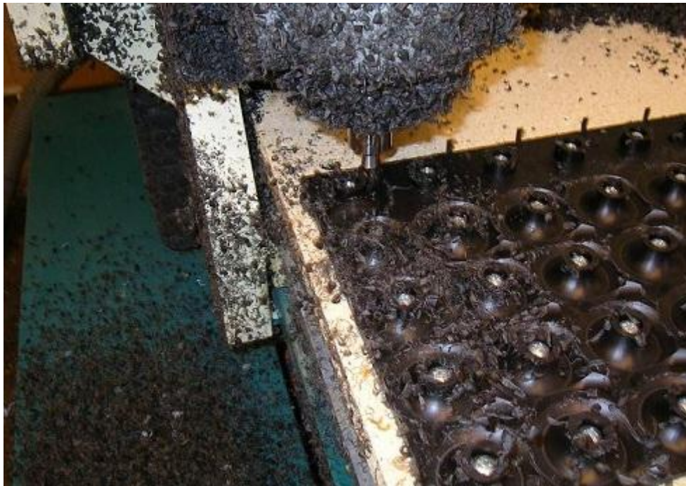
Fräsning av mindre serie POM-detaljer.
