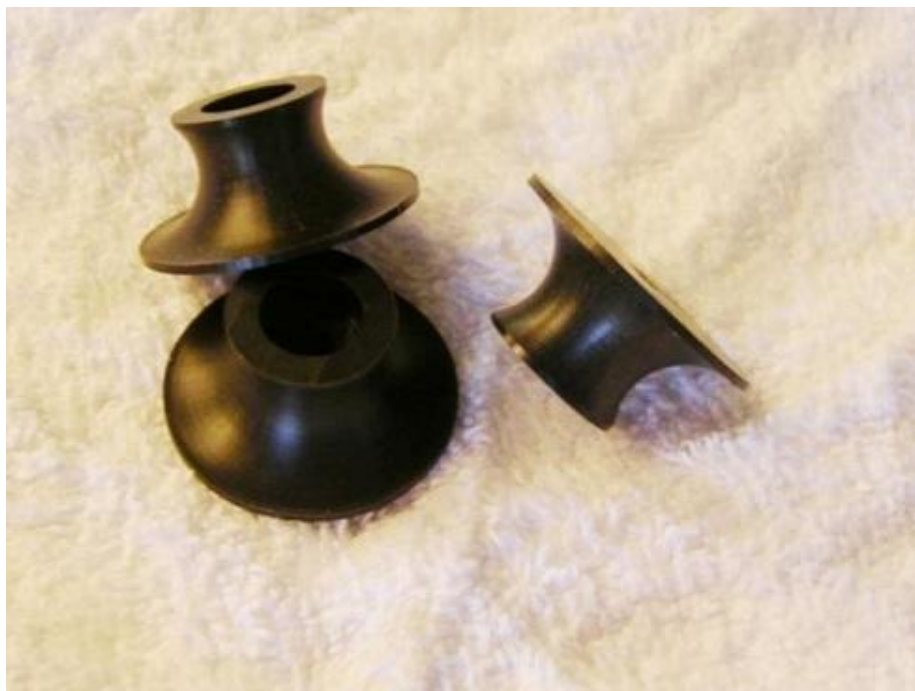
Fräsning av mindre serie POM-detaljer.
