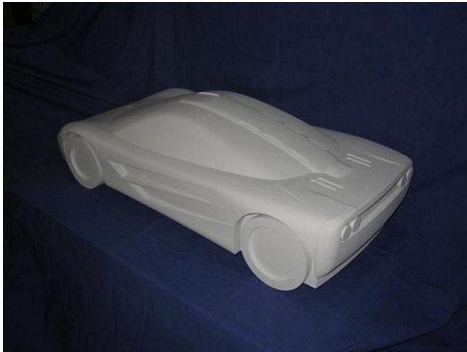
Skalmodell för verifiering av CAD-data.
