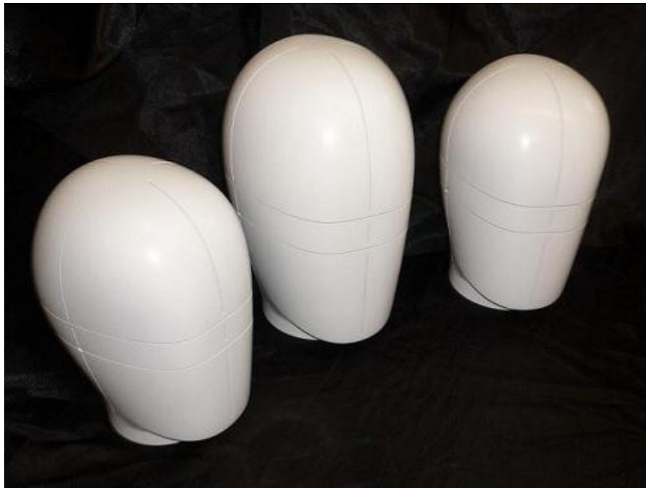
CNC-frästa huvudmodeller, material block 60, sprutspacklade och lackerade.
