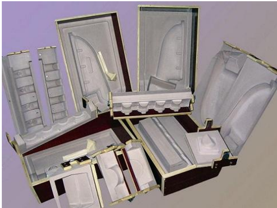
Gjuterimodeller och kärnlådor till plenum och insug.
