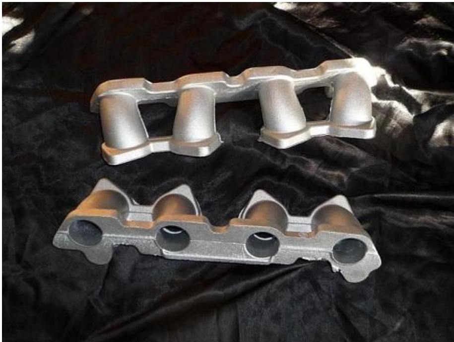
Sandgjutna aluminiumdetaljer innan efterbearbetning.
