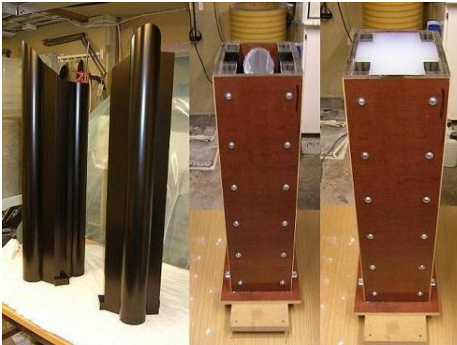
Modeller och formar till masverk.
