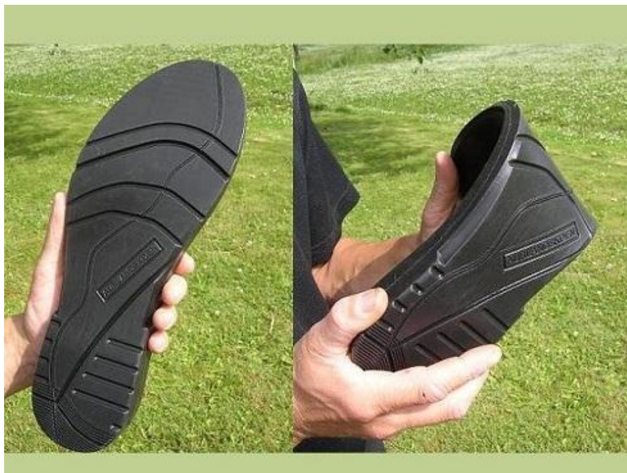
Gjuten prototyp av skosula, material polyuretanelastomer.
