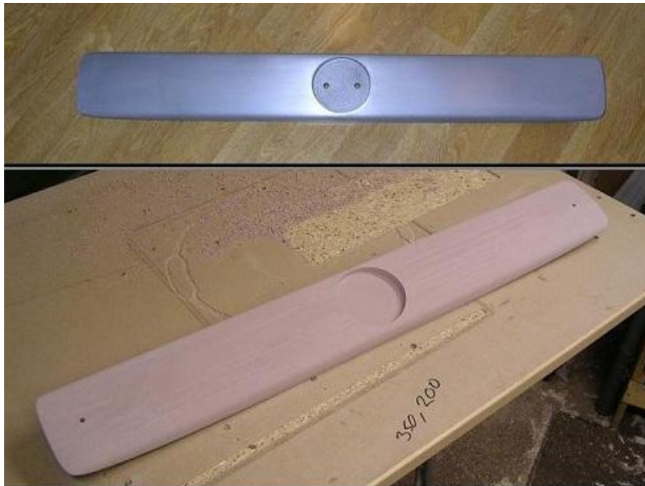
Prototyp på bordsmed i aluminiumfylld epoxi.
