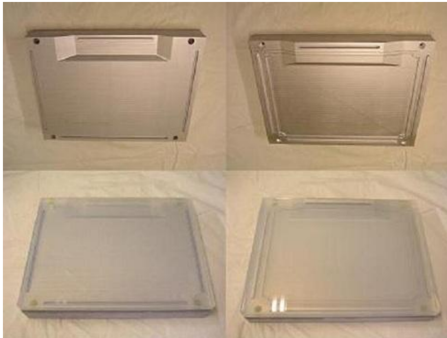
Masterform och silikonform till packning.
