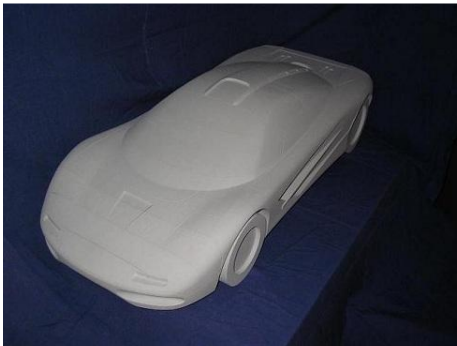
Skalmodell för verifiering av CAD-data.
