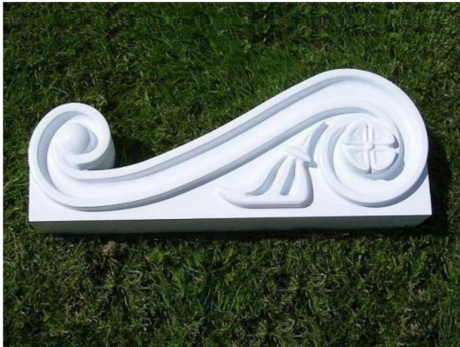
Modellunderlag till betongornament, material block 60, sprutspacklad och lackerad.
